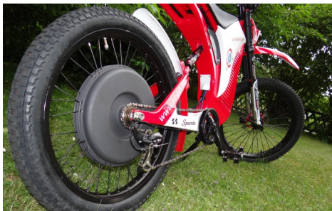
電動越野車搭載感應式輪轂馬達
