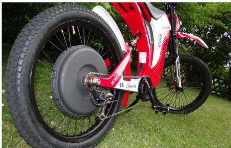
Biciclette elettriche con il motore del mozzo di induzione
