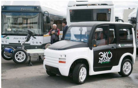
Mobil listrik Rusia pertama, Zetta, dilengkapi dengan empat motor hub
