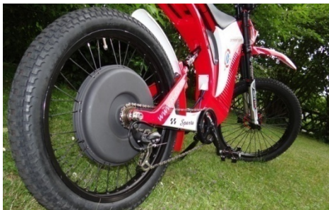
Sepeda listrik dengan motor hub induksi
