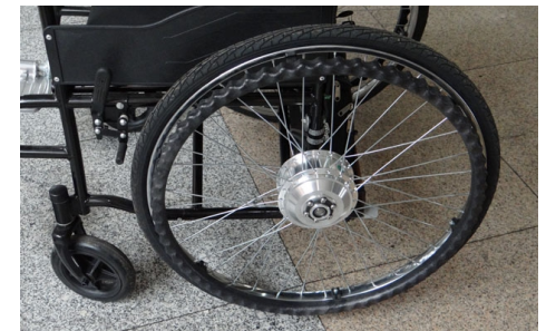
Unsere Radnabenmotoren für die Rollstühle
