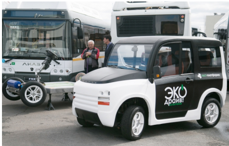
Das erste russische Elektroauto Zetta, ausgestattet mit vier Radnabenmotoren
