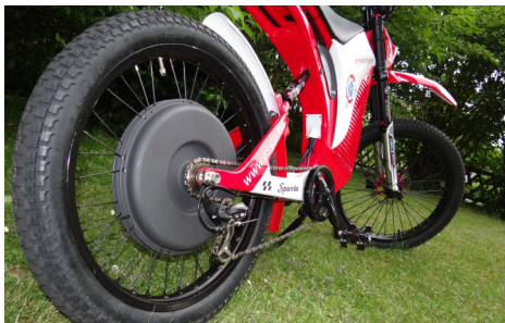
Elektrofahrräder mit dem asynchronen Radnabenmotor
