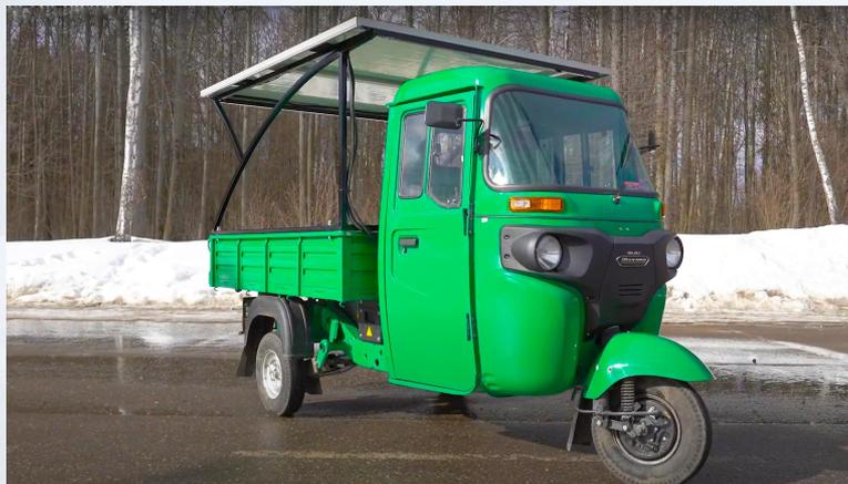
**КОМПАНИЯ «СТИИН» УСТАНОВИЛА ДВИГАТЕЛЬ С СОВМЕЩЁННЫМИ ОБМОТКАМИ DA-90S НА ТРИЦИКЛ ВАЈАЈ МАХИМА. ЭТО ОДИН ИЗ САМЫХ ПОПУЛЯРНЫХ В МИРЕ ГРУЗОВЫХ ТРИЦИКЛОВ**
